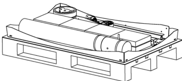
Positionnez un carton sur la palette. Positionnez le four sur le dos, sur la palette (cette opération doit être faite à deux personnes).
